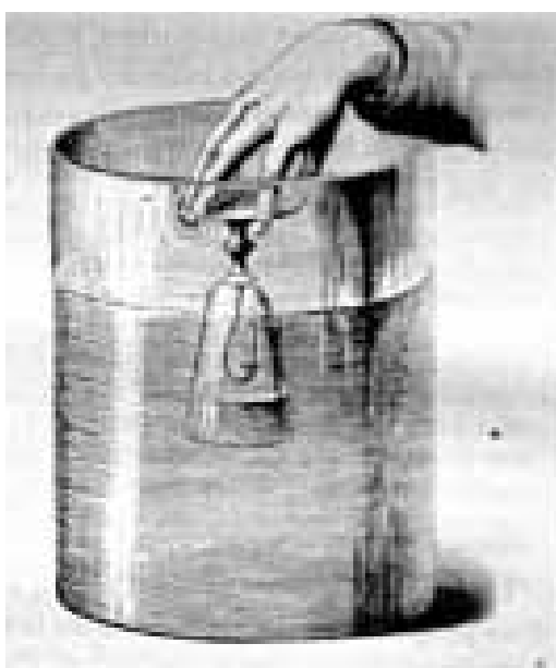
fig.1: Dal libro di Louis Figuier del 1870 "Les Merveilles de la Science" è ripreso questo disegno che evidenzia la compressione dell'aria all'interno del bicchiere/campana immerso.
